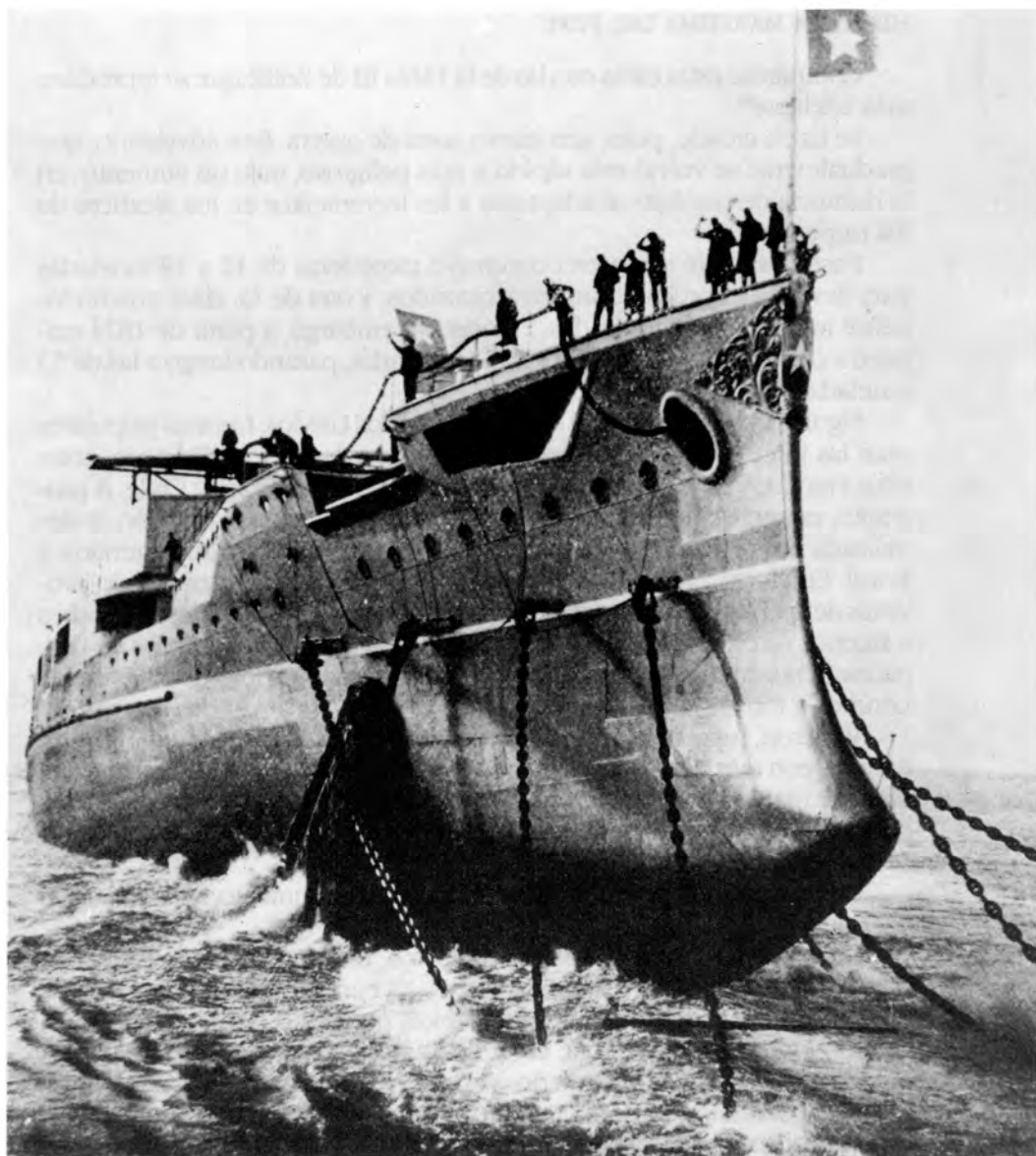
Lanzamiento del blindado chileno Libertad , adquirido luego por Inglaterra bautizándolo como H.M.S. Triumph . Nótese el área desprotegida al impacto de torpedo por debajo de la línea de flotación. (Reproducida de: Submarines of the World's Navies , 1911, por Charles W. Domville-Fife)
