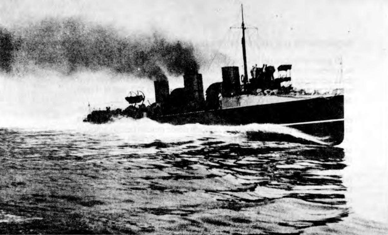
El destructor inglés Viper , a turbina, navegando a 30 nudos. Nótese la forma de caparazón de tortuga de la cubierta en proa, para alojar sus torpedos. Los destructores de 30 nudos estaban destinados a buscar a su adversario submarino. (Reproducida de: Submarines of the World's Navies , 1911, por Charles W. Domville-Fife).
