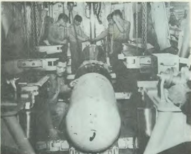
LUEGO DE HABER DESCENDIDO POR LA CUNA, en forma inclinada, el torpedo se coloca horizontalmente por medio de aparejos y diferenciales que son maniobrados por los expertos torpedistas peruanos. Posteriormente serán introducidos al tubo lanzatorpedo designado.
