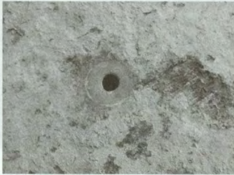
Detalle del oído o fogón.
