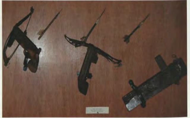
Ballestas confeccionadas en base a láminas de tubo de PVC y madera
